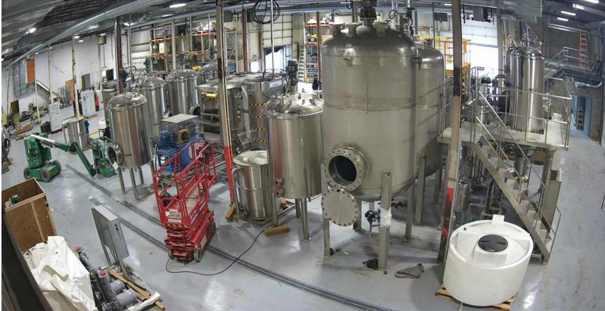
Figure 1: Vue de l'assemblage de l'usine de démonstration de recyclage des terres rares
